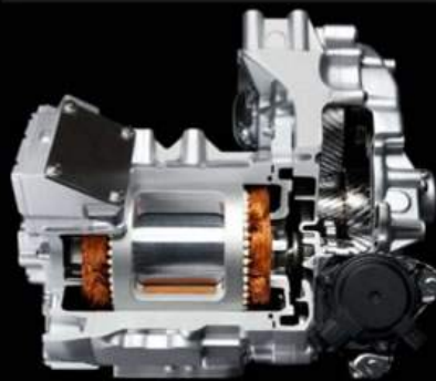
Detalle motor eléctrico y grupo reductor
